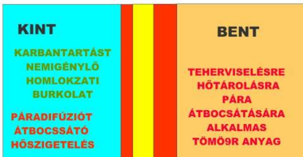
18/A.sz. ábra KÜLSŐ TÉRHATÁROLÓ FALSZERKEZET FUNKCIÓ SZERINTI FELOSZTÁSA
